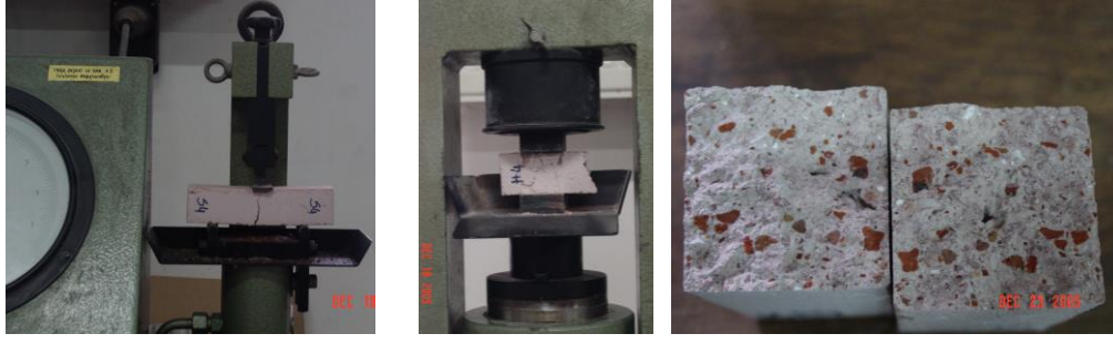
Şekil 5. Onarım harcı numunelerinin mekanik özellik deney resimleri
